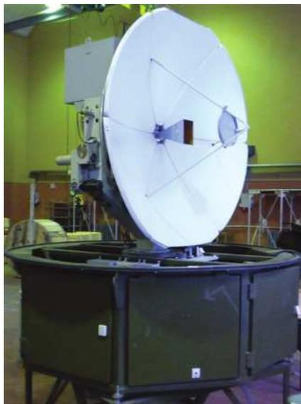
Рис. 23. Внешний вид малогабаритного метеорологического радиолокатора «Зодиак»
