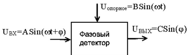
Рис. 9. Функциональная схема фазового детектора
