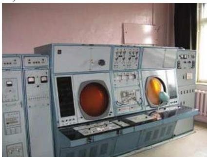
Рис. 4. Метеорологический радиолокатор МРЛ-5: а – внешний вид; б – пульт индикатора метеоролога
