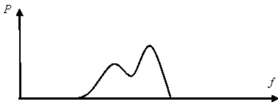
Рис. 13. Пример энергетического спектра эхо-сигнала метеорологического образования
